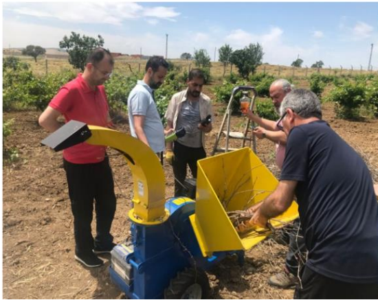
Şekil 4. Budama artıklarının makinaya yedirilmesi deneylerinden görünüşler
